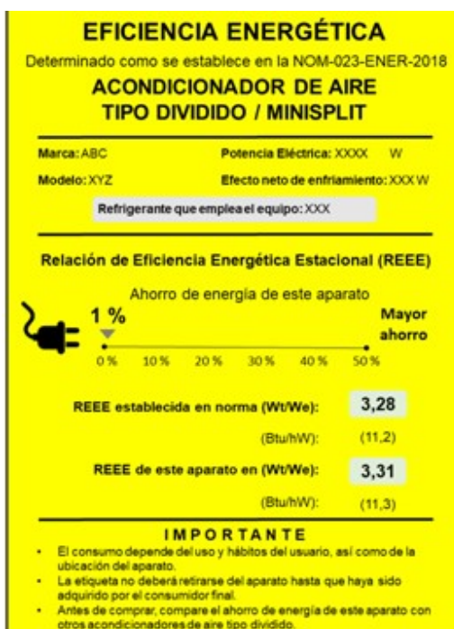
Figura A.9-Ejemplo de etiqueta para acondicionadores de aire tipo dividido, descarga libre y sin conductos de aire
